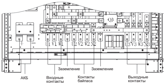
Рисунок 21 – Шина с клеммами для моделей 160 – 200 кВА
